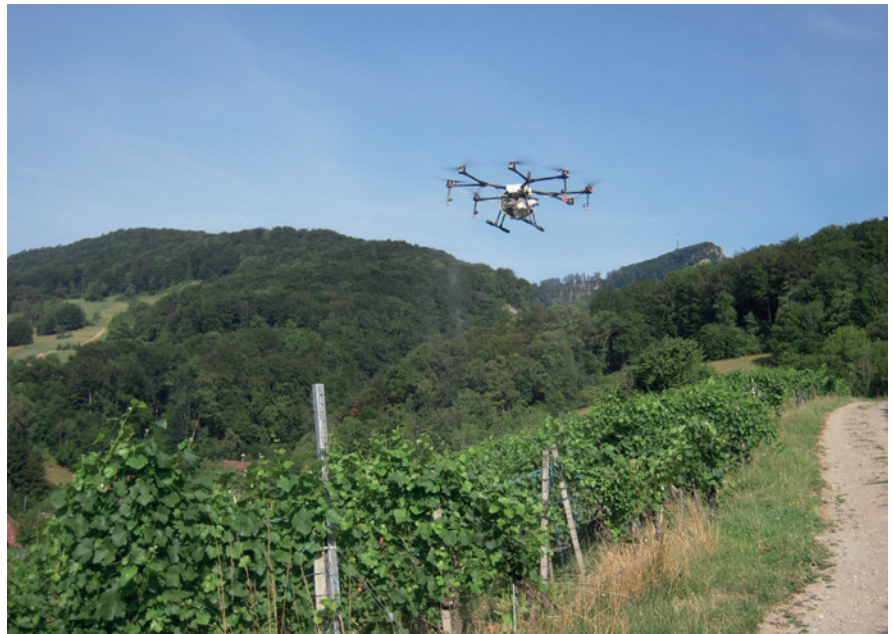
Drohneinsatz bei der Applikation von Pflanzenschutzmittel im Weinbau.
