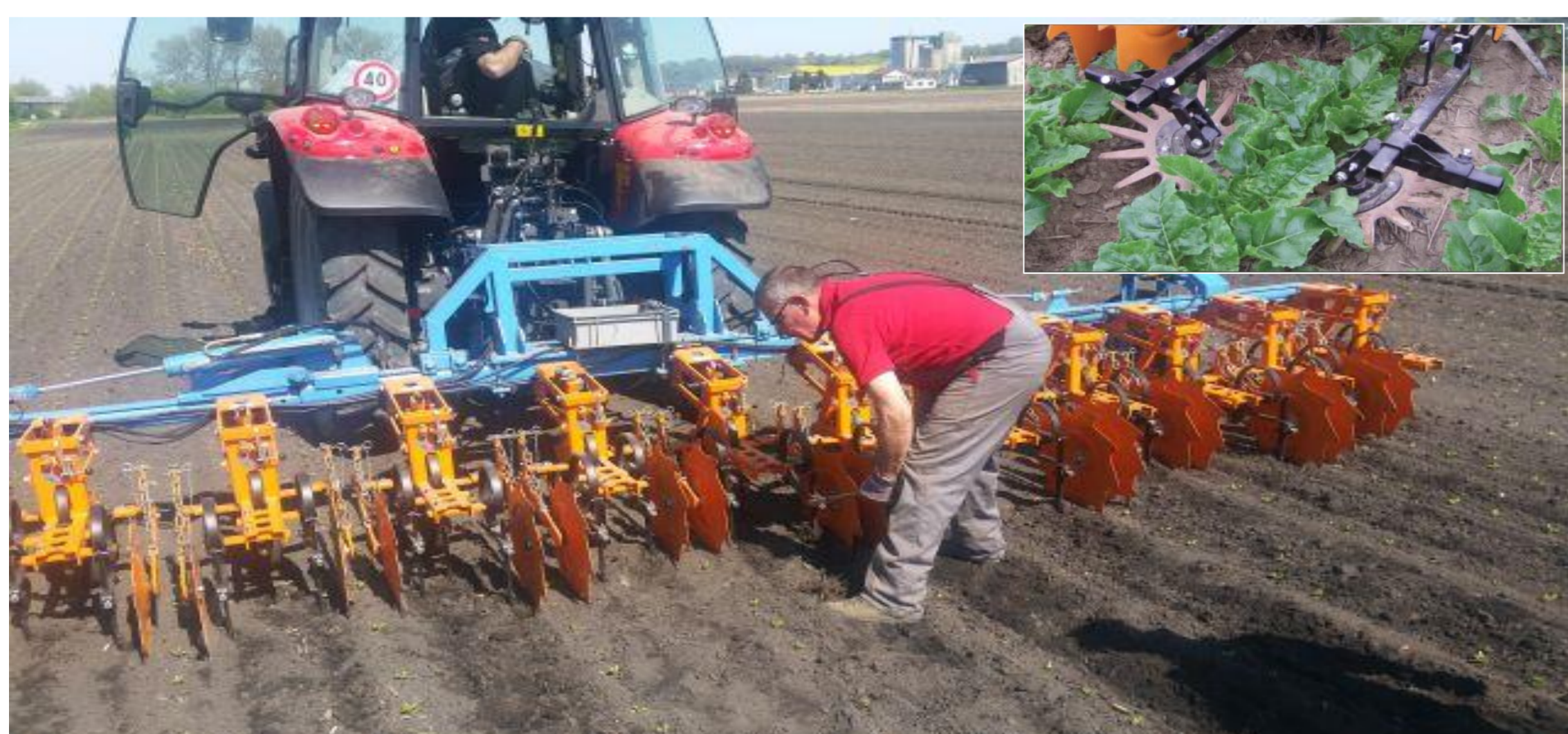
12-reihiges Hackgerät von Schmotzer mit Fingerhackelementen für die Unkrautbekämpfung in den Reihe
