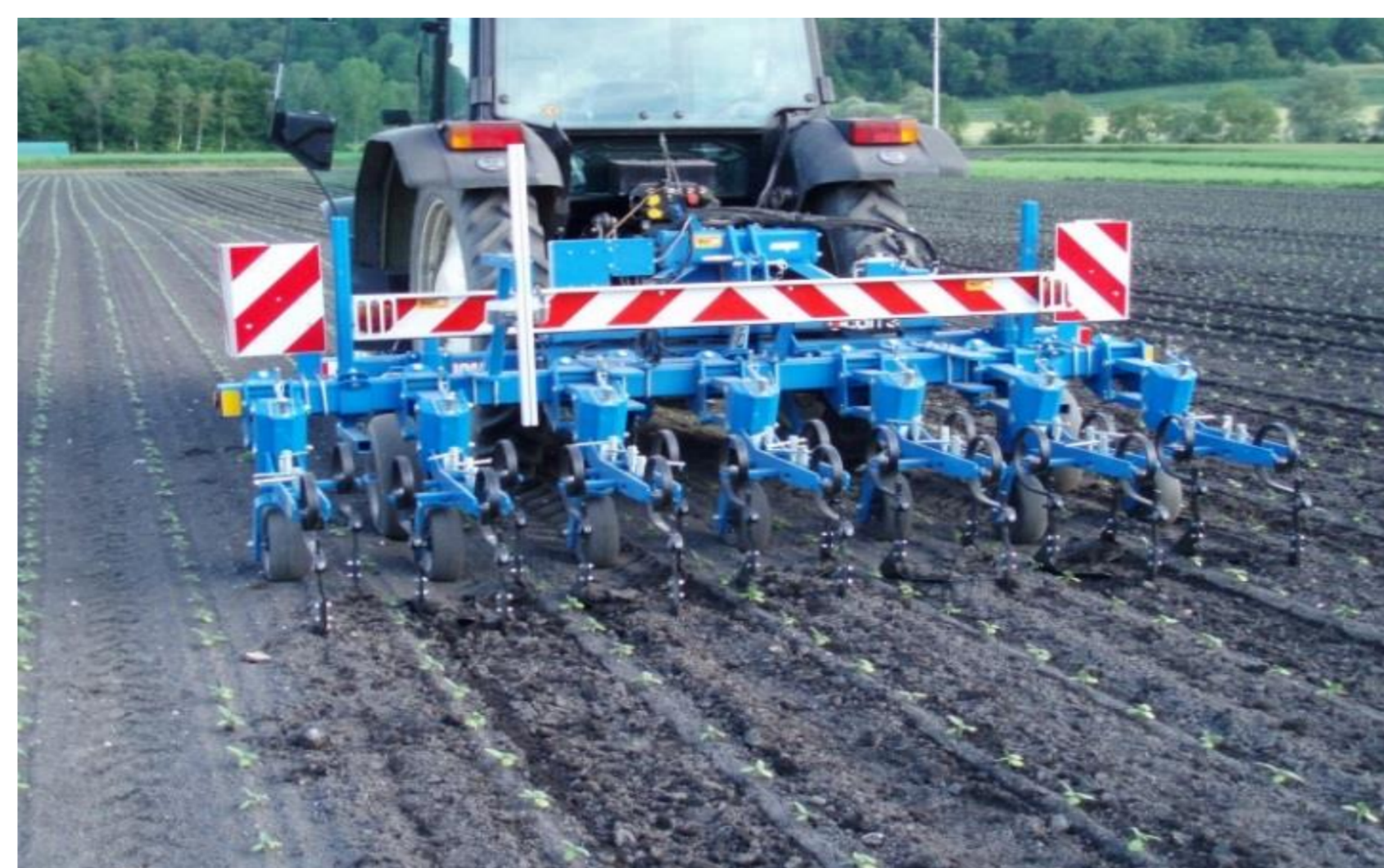
Hackgerät vom Typ Carré mit einer Arbeitsbreite von 3m
