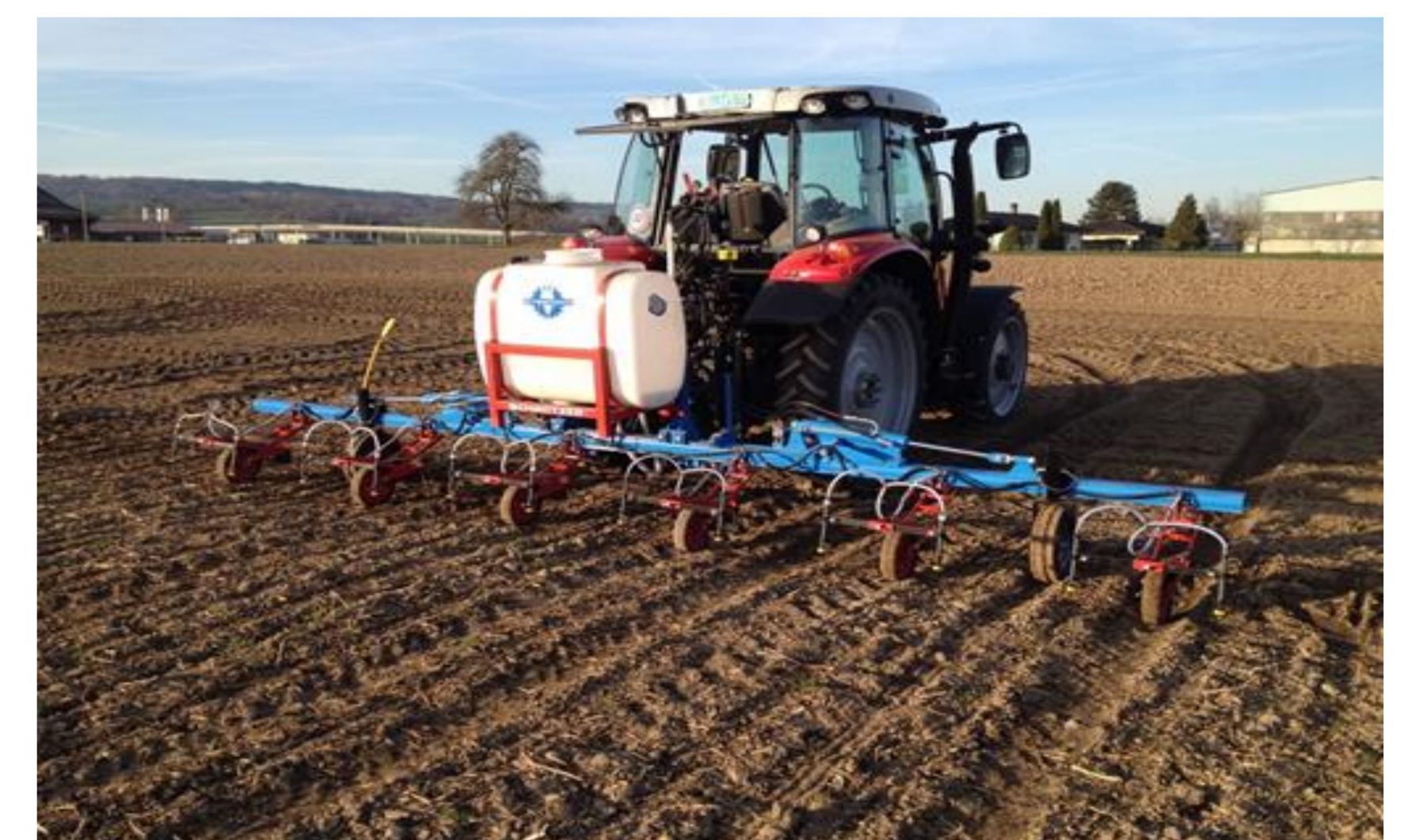
Bandspritzgerät mit einer Arbeitsbreite von 6 m mit 12 Flachstrahldüsen vom Type ES von Lechner
