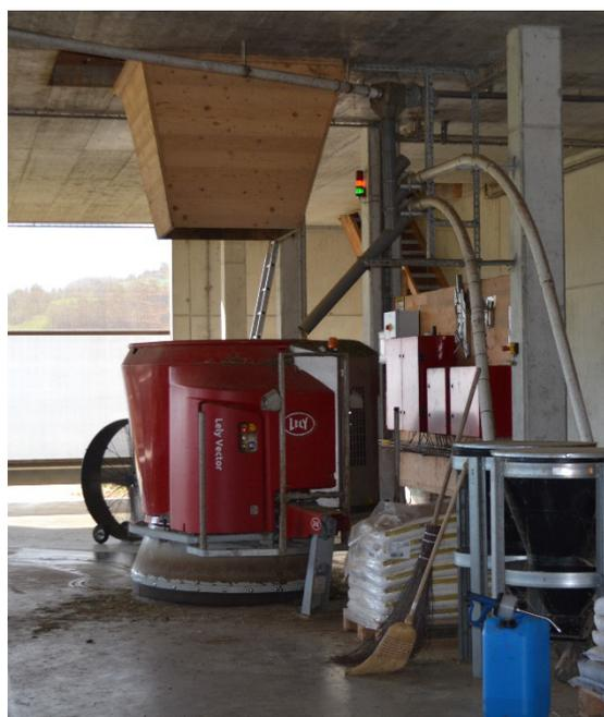
*... und befördert sie über einen Trichter in den darunter stehenden Fütterungsroboter.*
