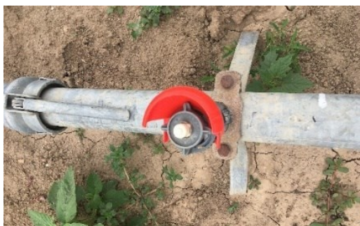
Illustration 12 : Protection contre le vent pour sprinkler (modèle Wind Fighter).
