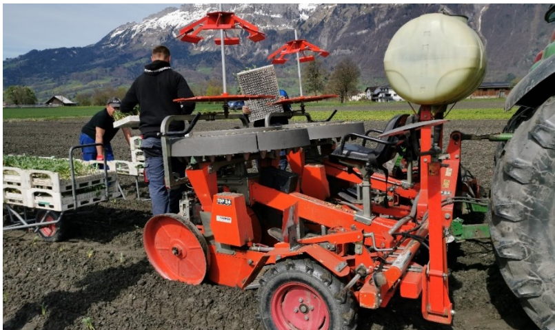
Illustration 13 : Planteuse avec réservoir d'eau pour arroser et fertiliser de manière ciblée lors de la plantation.
