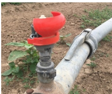
Illustration 12 : Protection contre le vent pour sprinkler (modèle Wind Fighter).
