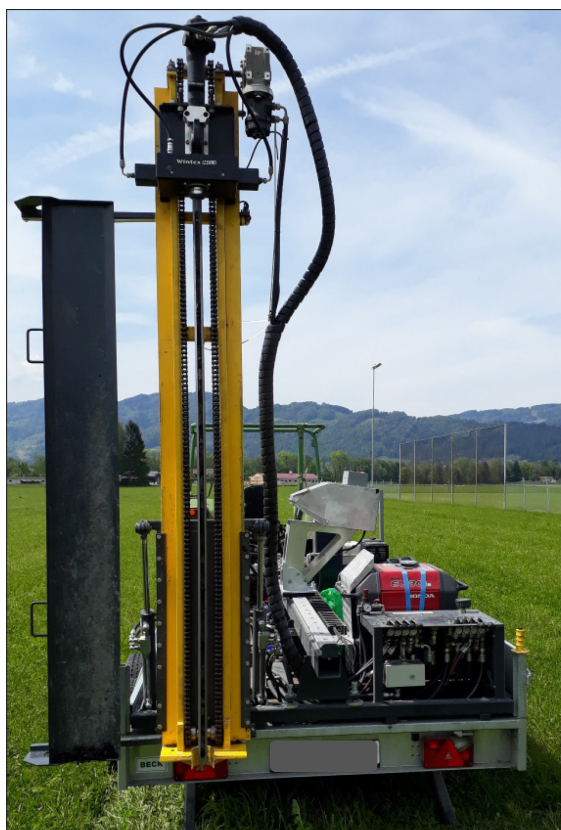
Bohrgerät für maschinelle Bohrungen
