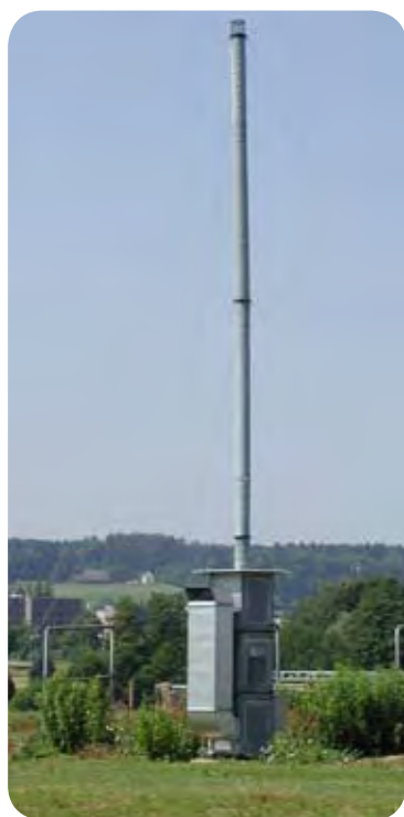
Fig. 17: Trappola ad aspirazione in uso presso ACW e ART per il rilevamento giornaliero del numero di afidi.
