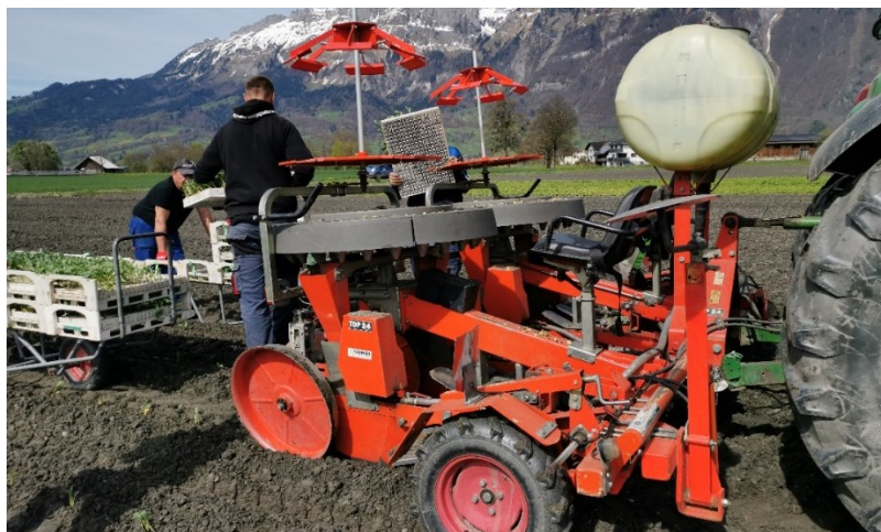
Figura 13 Seminatrici con serbatoio d'acqua per annaffiare e concimare in modo mirato le piantine durante la messa a dimora.
