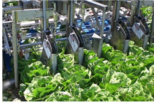
Figure 16 : Un jet d'eau coupe la laitue, après quoi la laitue est évacuée sur un tapis roulant (source : ramsayhighlander.com).
