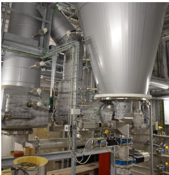
Der untere Teil des Schwebebettreaktors. Hier werden Fremdstoffe (Nägel, Schrauben, Steine usw.) durch die Schwerkraft nach unten abgeschieden.
