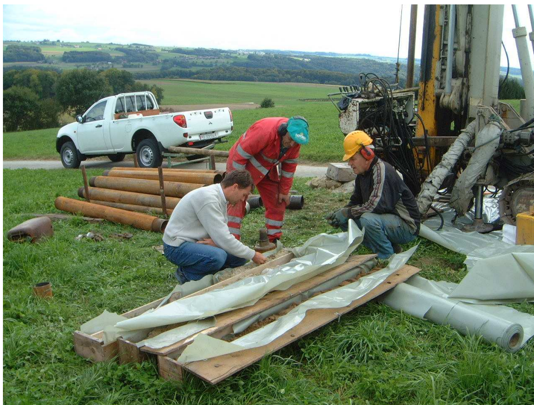
Abb. 5. Beurteilung eines Bohrkerns in Fétigny
